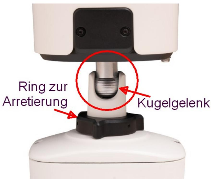
Die Außenanlage sollte auf einer Höhe zwischen 2,20 m und 8 m oberhalb des Bodens befestigt werden. Um eine optimale Bildqualität zu erreichen, sollte vermieden werden, die Kamera einem direkten Gegenlicht auszusetzen.
